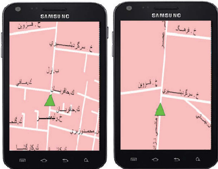
نگاره ۱۰- نقشه‌های تولید شده با سطوح جزئیات متفاوت در سرعت‌های 25km/h (سمت راست) و سرعت 55 km/h (سمت چپ)
