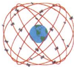
نگاره (۶): بخش فضایی سیستم تعیین موقعیت GPS شامل ۲۴ ماهواره در ۶ مدار در فواصل مساوی [9]
