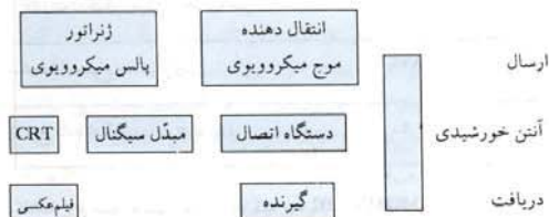
نگاره (۲۵): مؤلفه‌های یک سیستم نمونه‌ای SLAR
