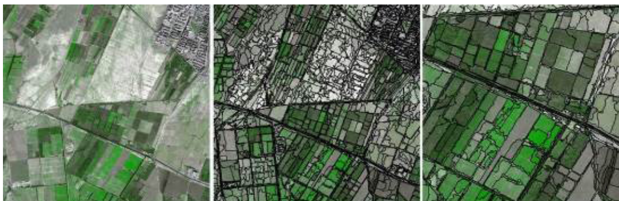
نگاره ۱: قطعه‌بندی تصویر با مقیاس ۱۶۰ (ضریب شکل ۰,۵ و فشردگی ۰,۳)
