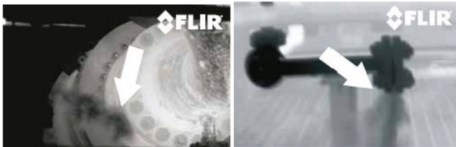
نگاره ۱۰: تشخیص نشت گاز (محل فلش‌ها) با استفاده از دوربین‌های حرارتی
