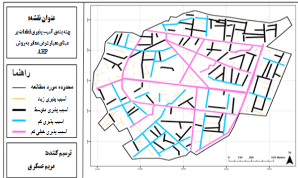
نگاره ۶: آسیب پذیری ساختمانها به روش AHP بر مبنای معیار عرض معابر
