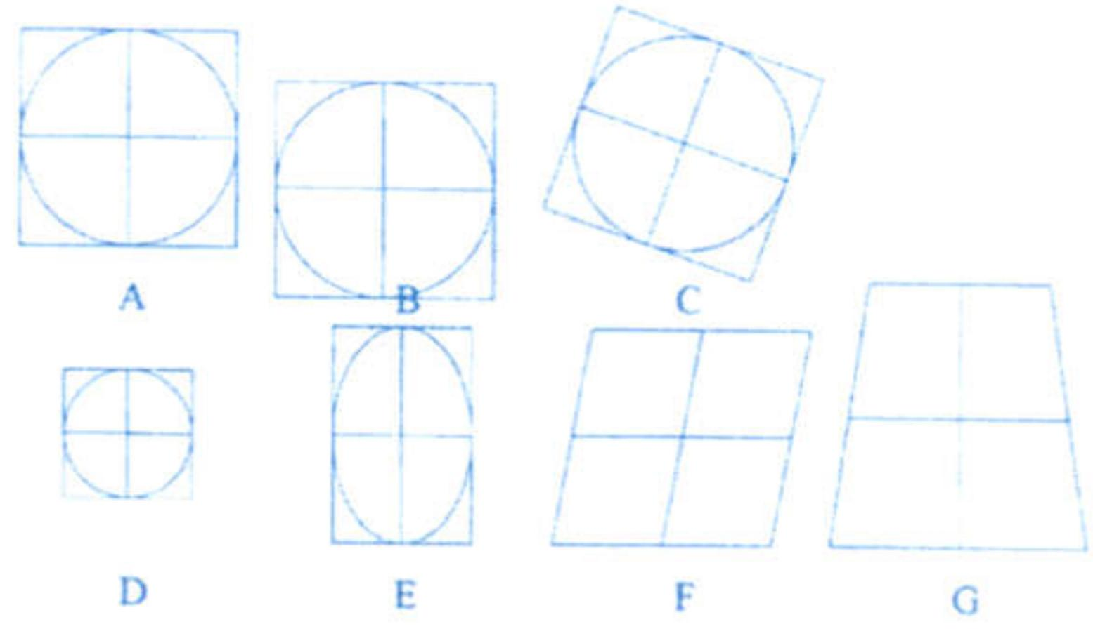
نگاره (۲): بعضی از تبدیلات هندسی. تصویر در A در B برگردان شده و در C دوران پیدا نموده است. مقیاس در D تغییر پیدا کرده و تصویر در E کشیده شده به نحوی که فقط مقیاس افقی تغییر یافته است. تصویر در F بُرشی پیدا کرده است. تبدیلات پیچیده‌تر شامل تصویر پرسپکتیو G است که در آن تغییر مقیاس در روی تصویر تفاوت پیدا می‌کند.
