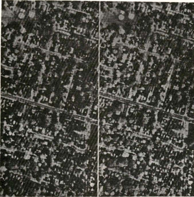
نگاره (۳): یک زوج تصاویر دیجیتالی استریو از ناحیه شهری که توسط دوربین دیجیتالی کداک MEGAPLU1.4 برداشته شده است، اندازه سلول وضوح زمینی در این دو تصویر 0.7\mu\text{m} در هر پیکسل است. مقیاس 1:7300 می باشد - دانشگاه Carleton کانادا.
