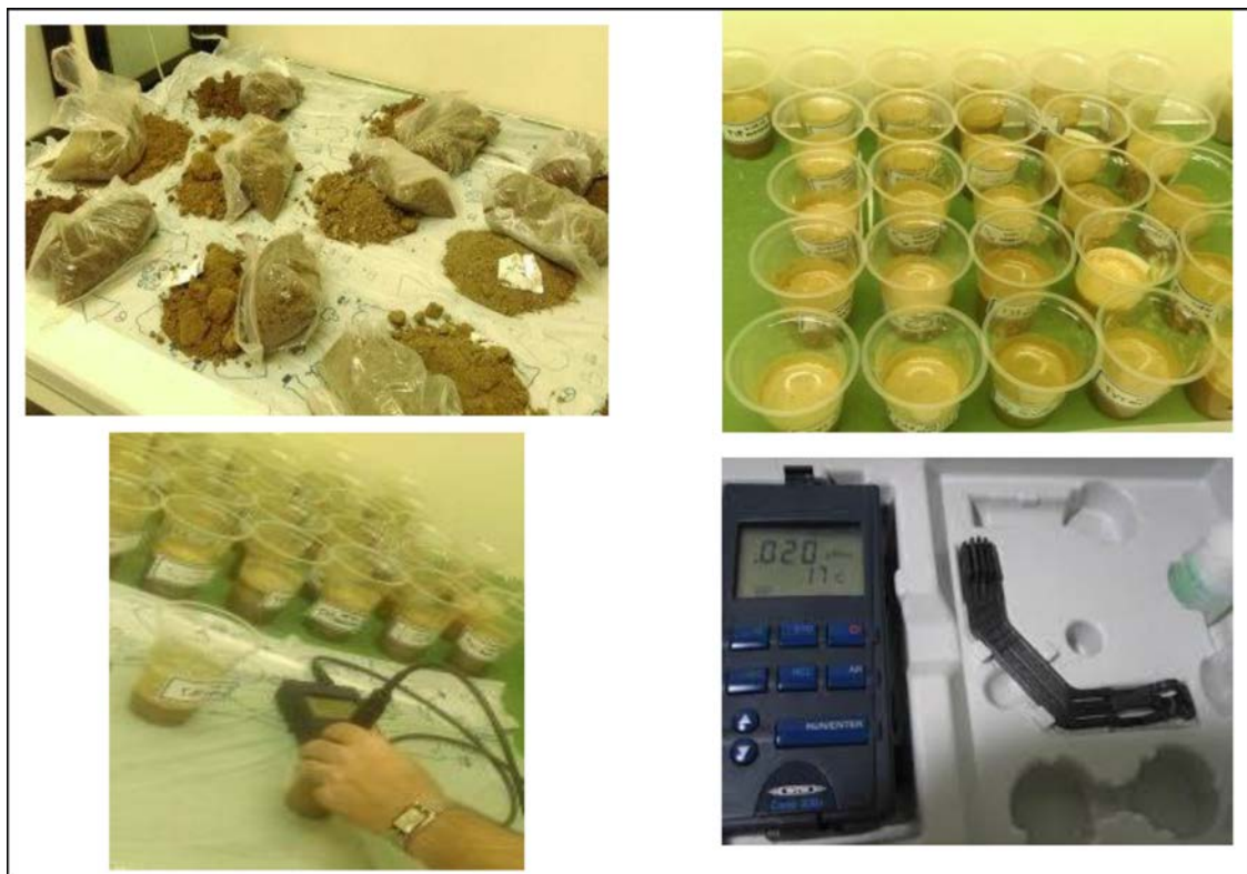
نگاره ۲: نمونه خاک‌های برداشتی از منطقه مطالعاتی و اندازه‌گیری هدایت الکتریکی عصاره اشباع با استفاده از دستگاه WTW Cond330i
