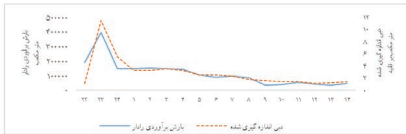
نگاره ۱۶: نمودار بارش برآوردی رادار و دبی اندازه‌گیری شده سیل ۱۲ شهریور ۱۳۹۱
