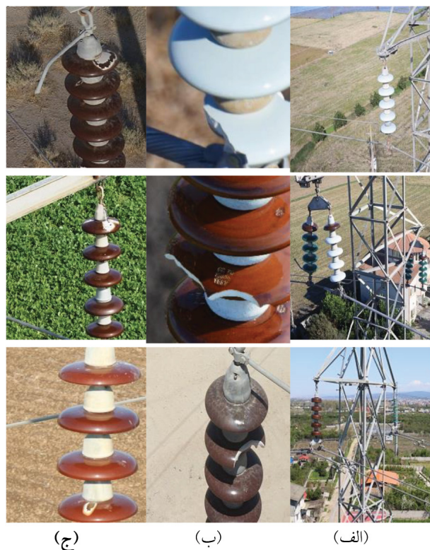
نگاره ۱: تصاویر نمونه مقره سالم و انواع عیوب مقره مورد تشخیص، ستون الف) مقره سالم، ستون ب) شکستگی در مقره و ستون ج) آرک‌زدگی مقره
