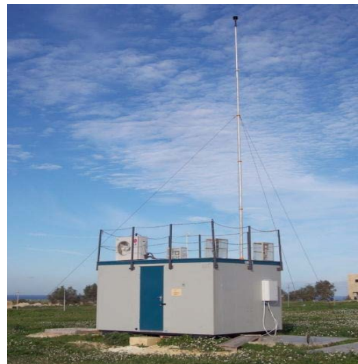
نگاره ۱: نمای بیرونی و درون یک ایستگاه زمینی پایش کیفیت هوا (سپهرنیا، ۱۳۹۴)
