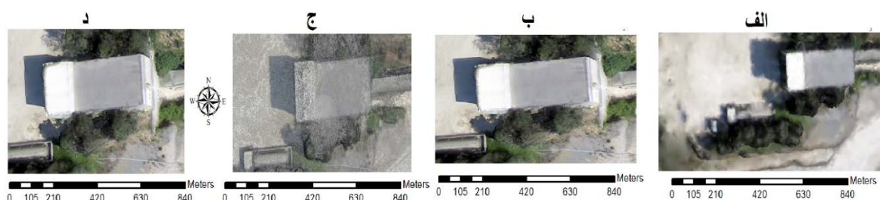
نگاره ۶: ابرنقاط با بافت، الف) UASmas، ب) Pix4D، ج) PhUAS، د) Agisoft
