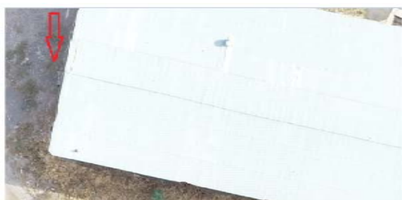
نگاره ۹: نمونه‌ای از ارتوفتو و نواقص در لبه ساختمان‌ها، الف) AgisMesh، ب) Pix4D
