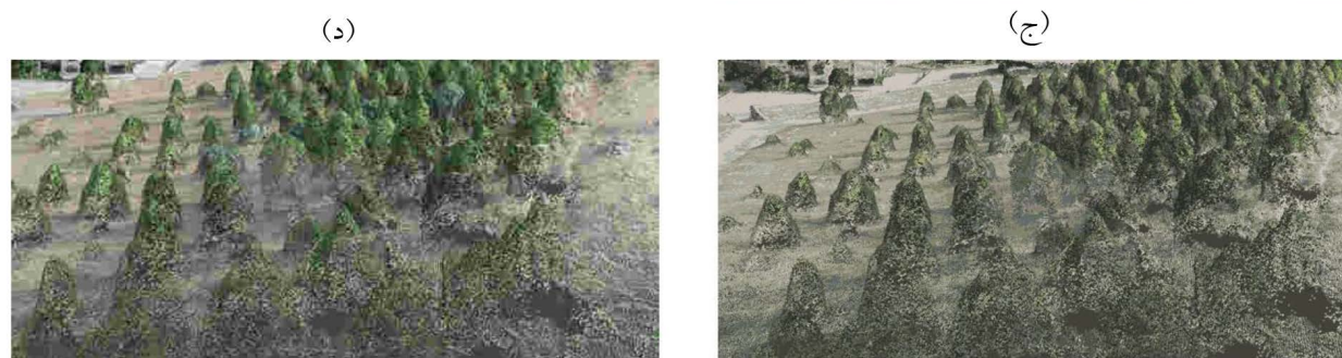
نگاره ۷: ابرنقاط در مناطق درختی، الف) با AgisMesh، ب) با Pix4D، ج) PhUAS، د) UASmas
