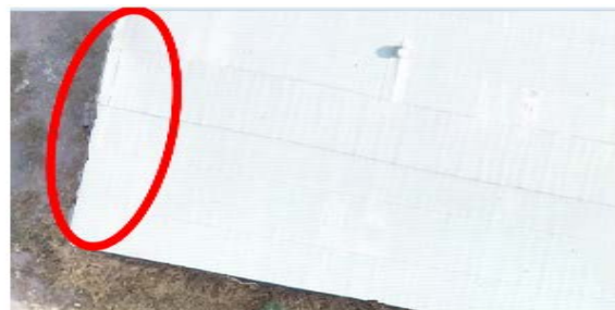
نگاره ۹: نمونه‌ای از ارتوفتو و نواقص در لبه ساختمان‌ها، الف) AgisMesh، ب) Pix4D
