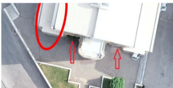
نگاره ۱۰: نمونه از ارتوفتو و نواقص در لبه ساختمان‌ها، الف) UASmas، ب) Pix4D
