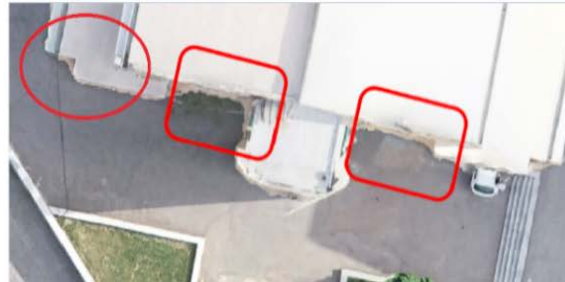
نگاره ۱۰: نمونه از ارتوفتو و نواقص در لبه ساختمان‌ها، الف) UASmas، ب) Pix4D
